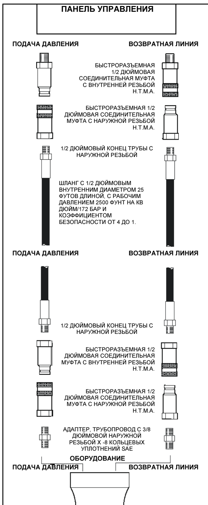
Рис. 2. Гидравлические подсоединения
